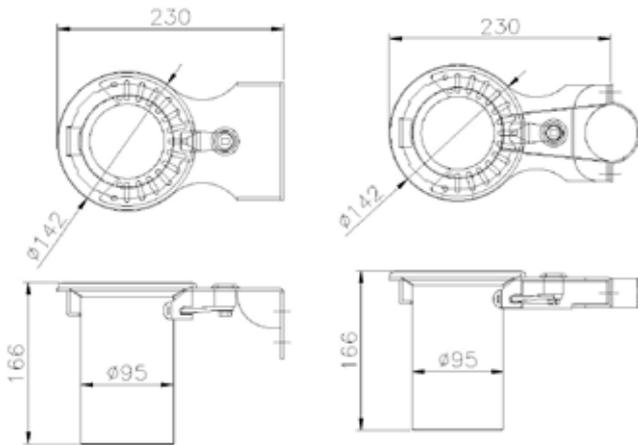
Contenitore posacenere in lamiera di acciaio zincato e verniciato a polveri poliesteri termoindurenti nei colori RAL. Predisposto per il fissaggio a un tubolare D. 55-60mm tramite apposite staffe a collare come abbinamento ai cestini portarifiuti, oppure impiegato singolarmente nella versione con supporto
