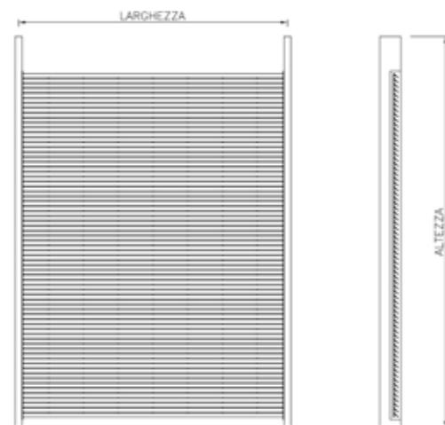
Pannello di schermatura in lamiera stirata sp.2 mm per isola ecologica formata da una struttura in acciaio zincato e verniciato o zincato a caldo, con dimensioni 200x200H. I montanti sono in IPE da 80 mm H.2200 mm, molto robusti ed adeguati a proteggere l'area da atti di vandalismo. L'isola può essere
