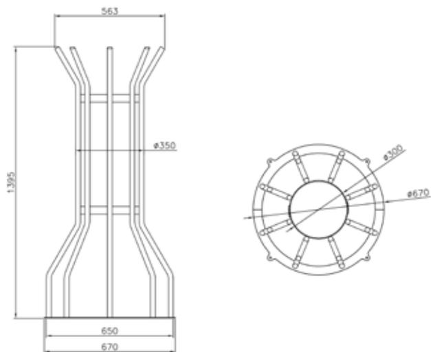
Il salva piante verticale è realizzato in tubolare Ø25 mm e sp. 1,5 mm con altezza 1,30 mt o 1,80 mt, in due pezzi che si fissano fra di loro tramite viti ed al suolo direttamente al pavimento se in cemento o alla griglia sempre tramite viti. Struttura in acciaio zincato e verniciato a polveri nelle varie colorazioni RAL, serve per proteggere le piante da atti di vandalismo o incuria. Può essere adeguata a diametri di pianta diversi.
